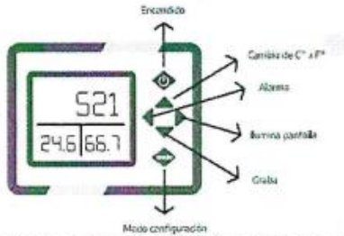
Pantalla de equipo portátil simple de medición de CO 2
